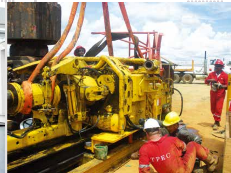
• Ремонт СВП VARCO VARCO top drive repair
