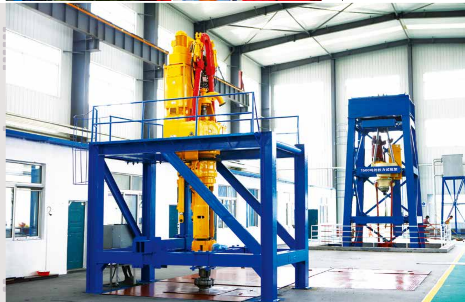
● Испытание на крутящий момент и силу растяжения Torque test and tension force test
